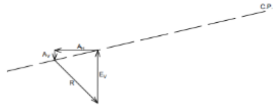
Slika 29. Određivanje reakcija Culmannovom metodom [10]
