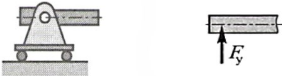
Slika 11. Vrsta oslonca-pomični oslonac [10]
