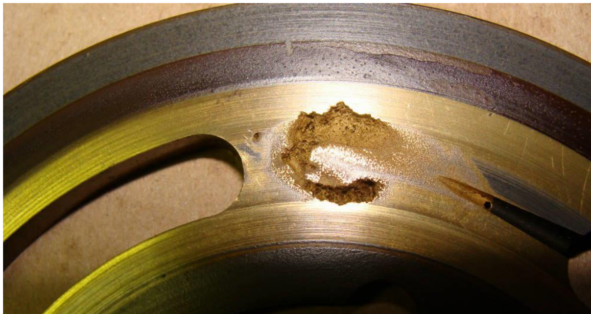
Slika 15.: Oštećenje od kavitacije na ploči ventila [11]
