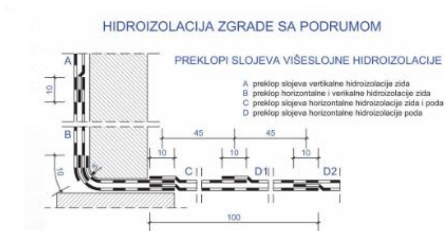
Slika 4. Detalji preklopa membrana
