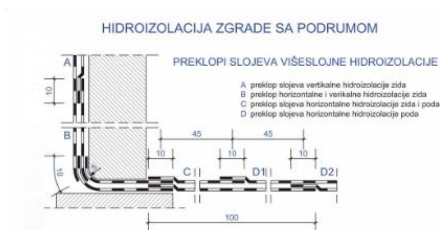
Slika 4. Detalji preklopa membrana
