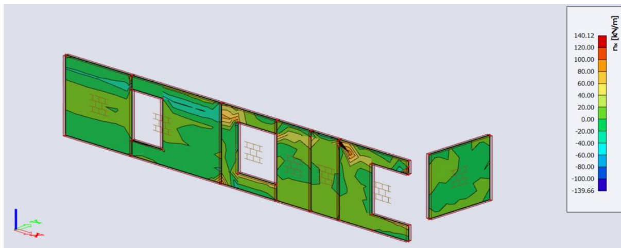
Slika 54 Poprečna sila u smjeru x-osi u zidovima od opeke prizemlja
