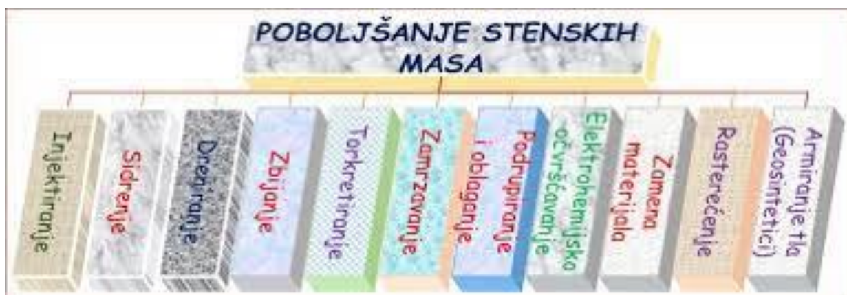
Slika 12: Shema metode poboljšanja stijenskih masa (Izvor: [13], Slika 8.)
