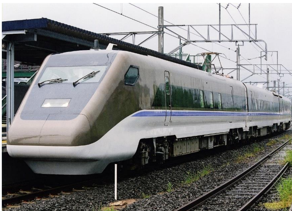
Slika 9.: Prva generacija japanskog vlaka s promjenjivim kolosijekom [31]
