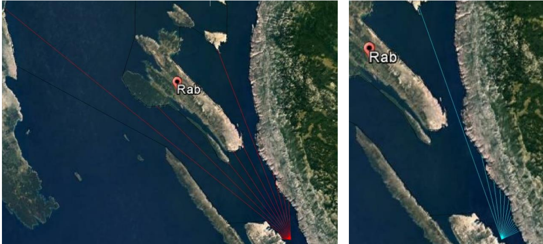
Slika 3. 6: Centralne zrake kroz smjer NW (lijevo), NNE (desno) i E (dole) te zrake sa korakom rotacije \pm 6^\circ od centralnih zraka
