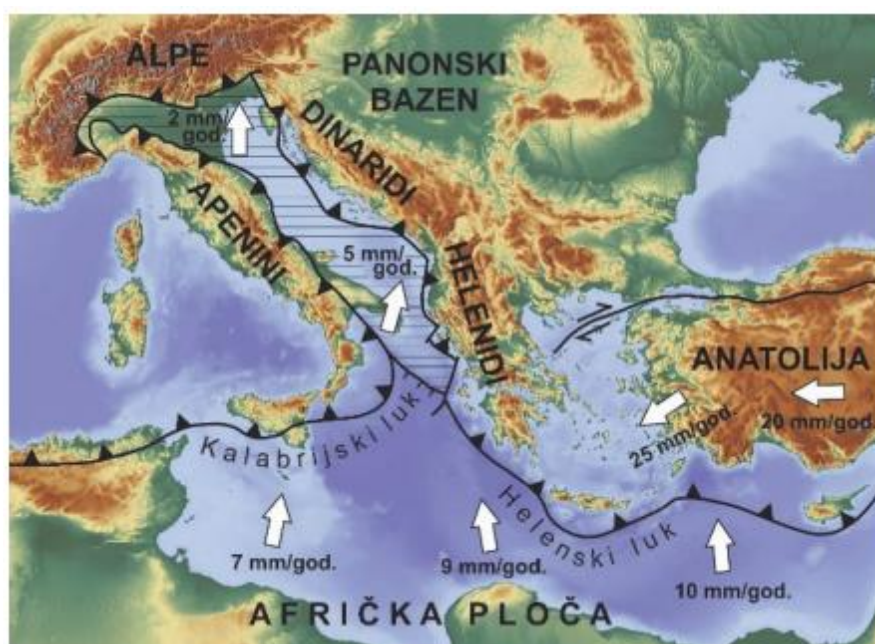
Slika 4. Geodinamička skica područja središnjega i istočnoga Sredozemlja i brzine konvergentnih kretanja Afričke (Nubijske), Anatolijske i Jadranske mikroploče (označena horizontalnim crtama) prema Euroazijskoj ploči (Izvor: [5])
