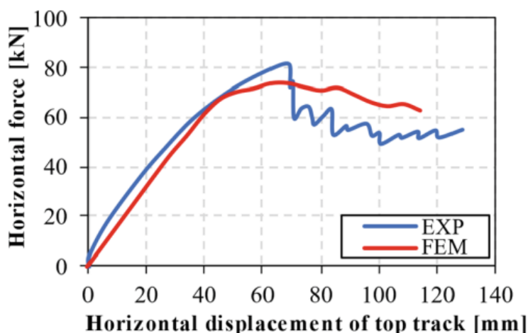
Slika 1.1 Usporedba eksperimentalne i numeričke krivulje (Izvor: [4])
