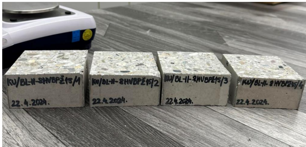
Slika 36. Uzorci lijevanoga betona s PDB-om za ispitivanje kapilarnog upijanja
