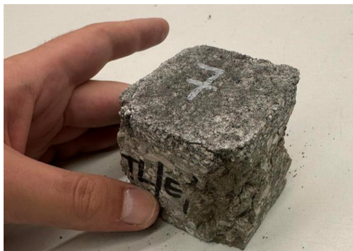
Slika 54. Uzorci vibroprešanog betona nakon ispitivanja tlačne čvrstoće
