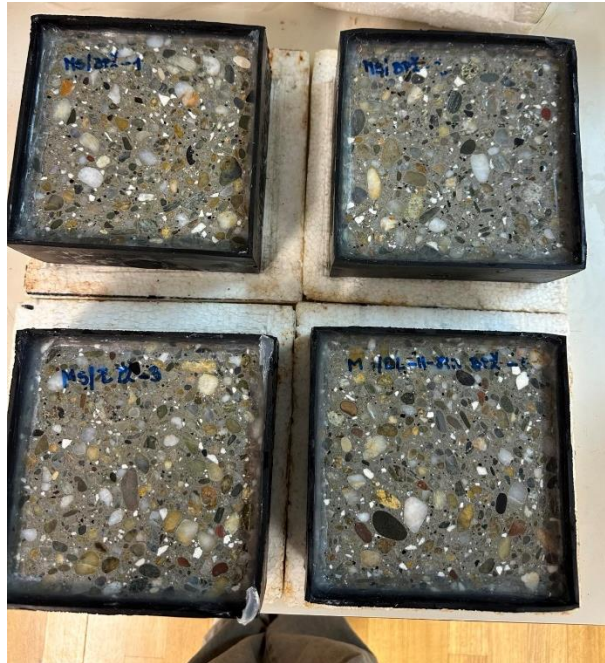
Slika 40. Prikaz pripreme uzoraka lijevanog betona s PDB-om na ispitivanje otpornosti na smrzavanja i odmrzavanja sa soli
