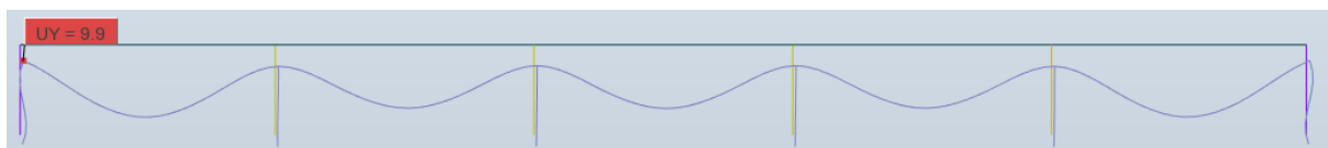
Slika 43. Pomak u smjeru y unutarnjeg okvira na dijelu prvog kata
