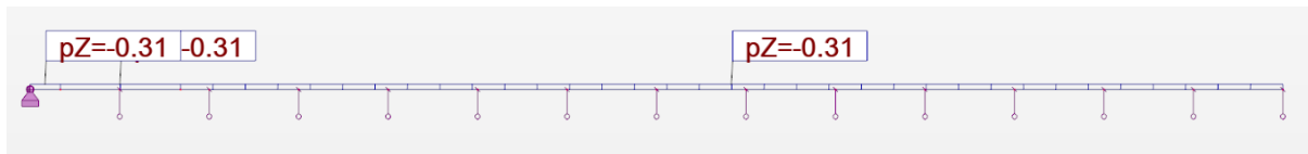
Slika 61.: Shema opterećenja pritiskajućim vjetrom
