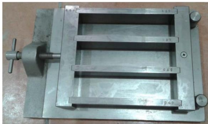
Slika 26: : Čelični kalup u koji je ugrađena mješavina [68]
