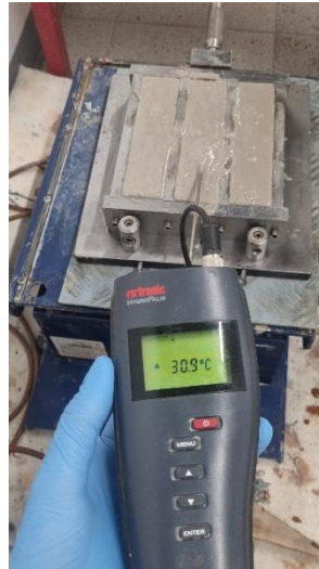
Slika 28: Mjerenje temperature mješavine
