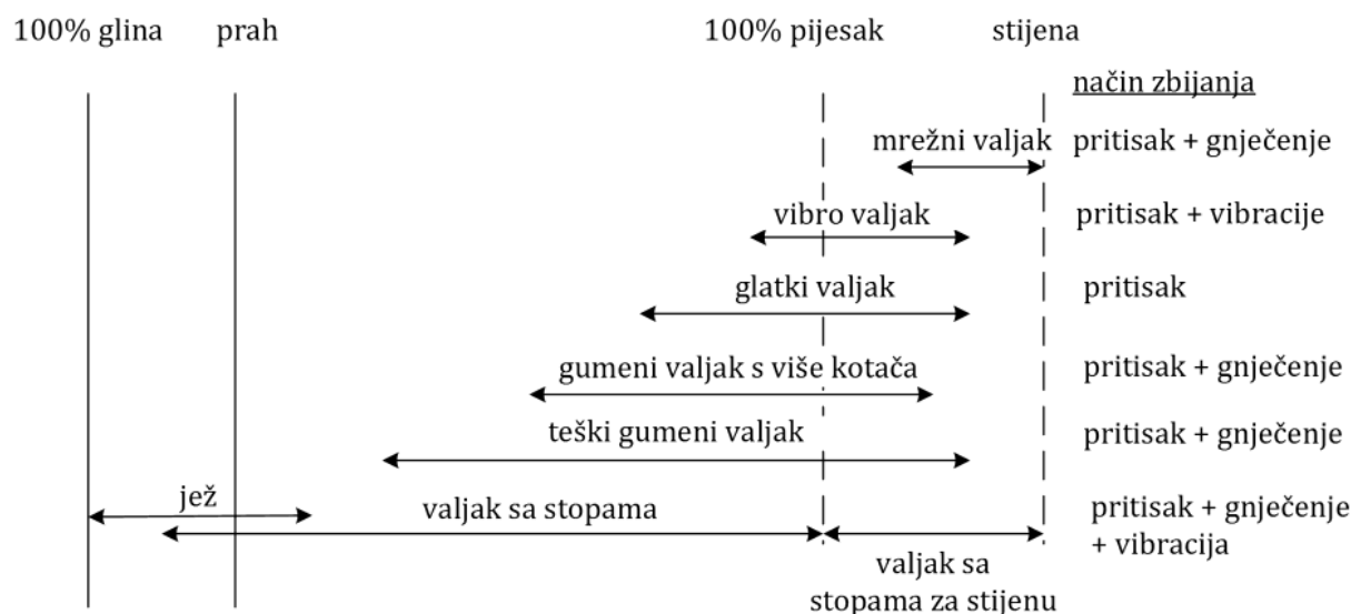
Slika 31. Prilagodna strojeva za zbijanje vrsti tla [2]
