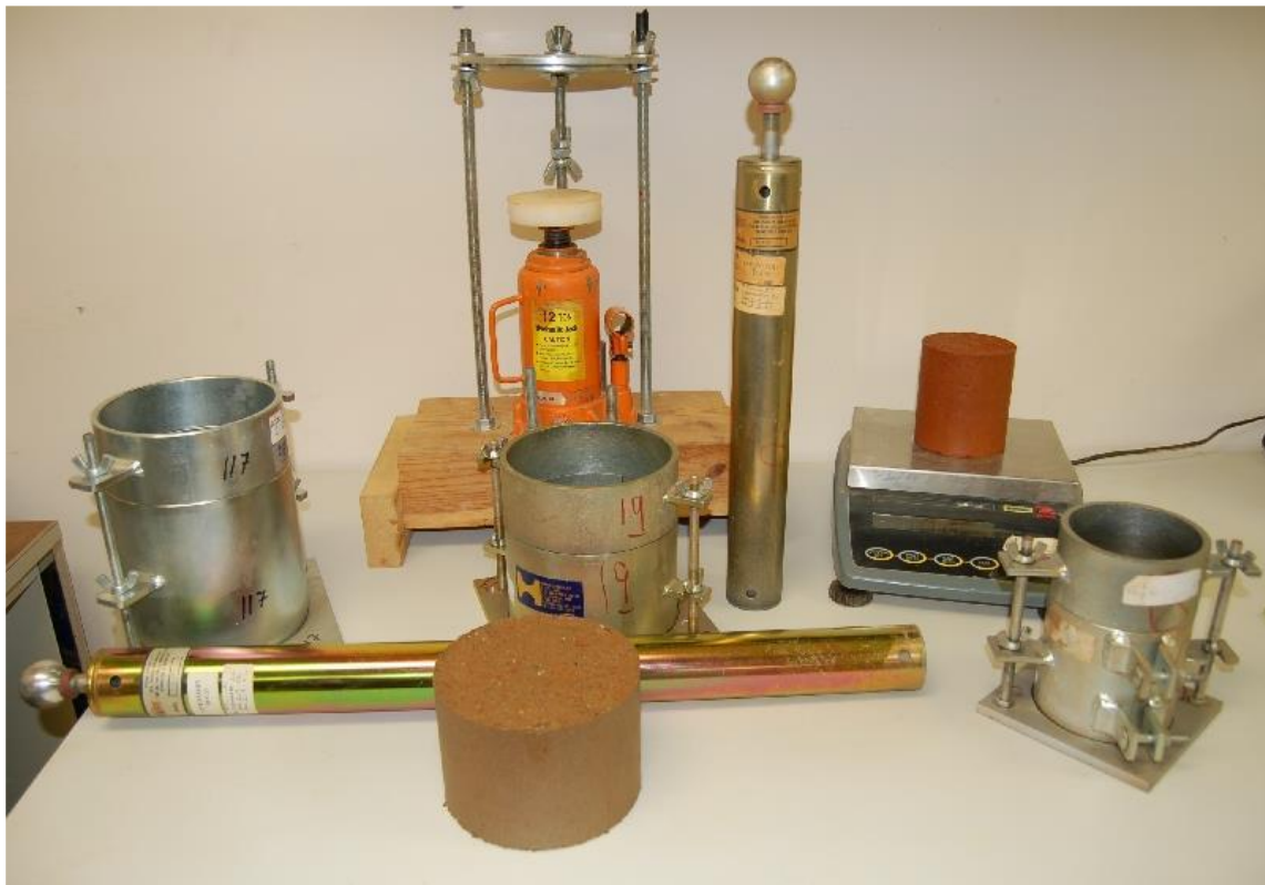
Slika 9. Oprema za Proctorov pokus [10]
