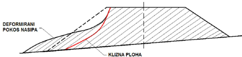
Slika 57: Klizanje pokosa nasipa (Izvor: [8])
