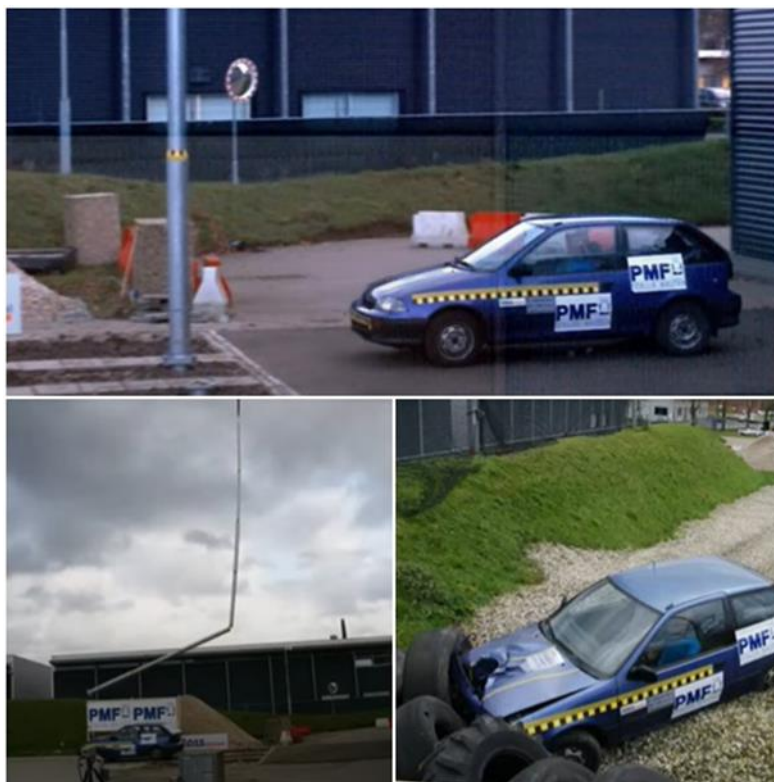
Slika 4.8. Pokusni sudar pri brzini od 100 km/h [19]
