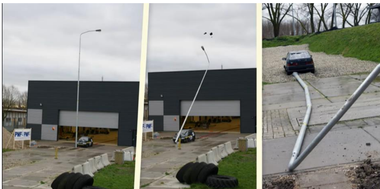
Slika 4.9. Pokusni sudar pri brzini od 35 km/h [19]
