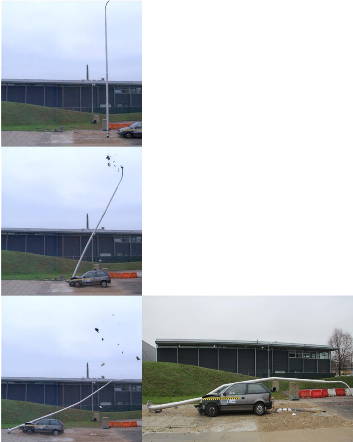
Slika 4.2. Pokusni sudar s visokoapsorbirajućim stupom [16]
