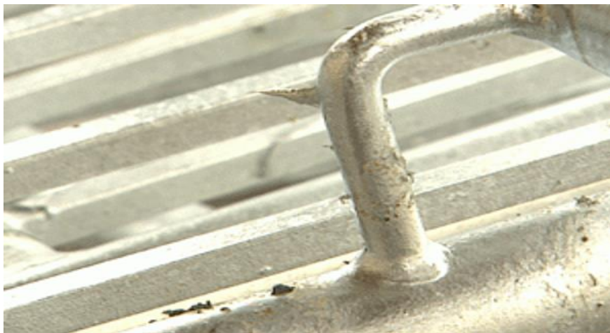
Slika 17.: Izbočine i mrlje na pocinčanom čeliku (Izvor: [23])
