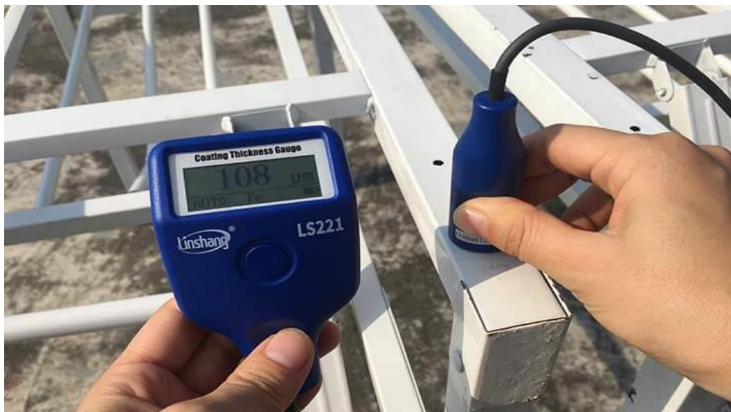
Slika 30.: Digitalni mjerac debljine boje (Izvor:[34])
