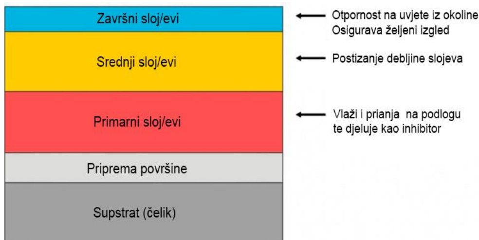
Slika 9.: Dijagram prikazuje sustav nanošenja opisanih slojeva na očišćenu površinu (Izvor: [1])
