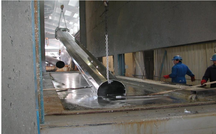
Slika 14.: Izranjanje čelika iz kupke – karakterističan sjajan izgled (Izvor: [22])
