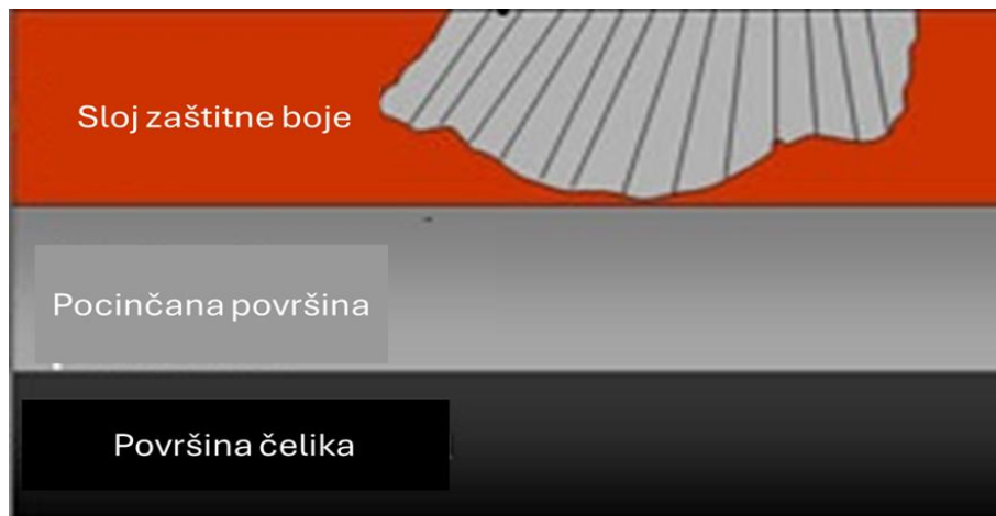
Slika 16.: Shematski prikaz dupleksnog sustava (Izvor: [15])
