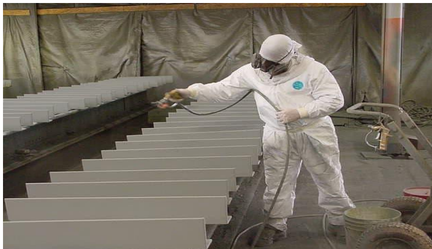
Slika 12.: Nanošenje zaštite raspršivanjem boje bez zraka (Izvor: [30])
