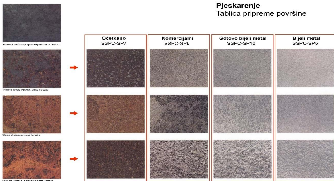
Slika 28.: Prikaz različitih stanja površine prema NACE-u (Izvor:[10])
