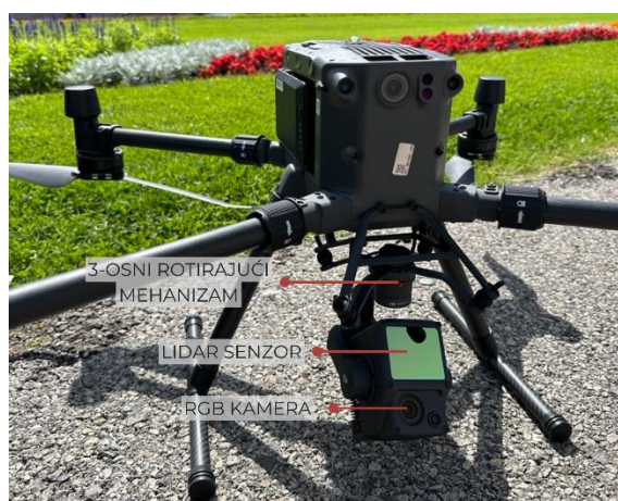
Slika 34. Dijelovi korištenog Zenmuse L1 senzora
