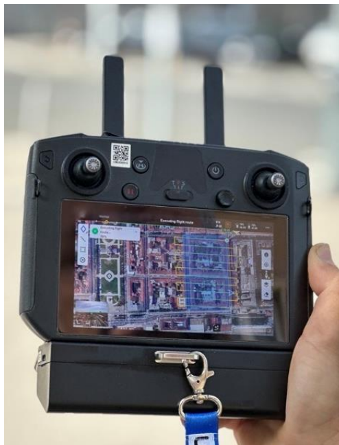
Slika 35. Podešavanje postavki opreme i rute letenja
