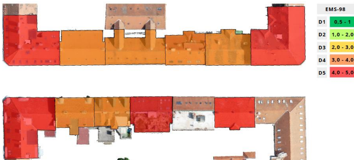
Slika 81.EMS 98 razred oštećenja za intenzitet VIII
