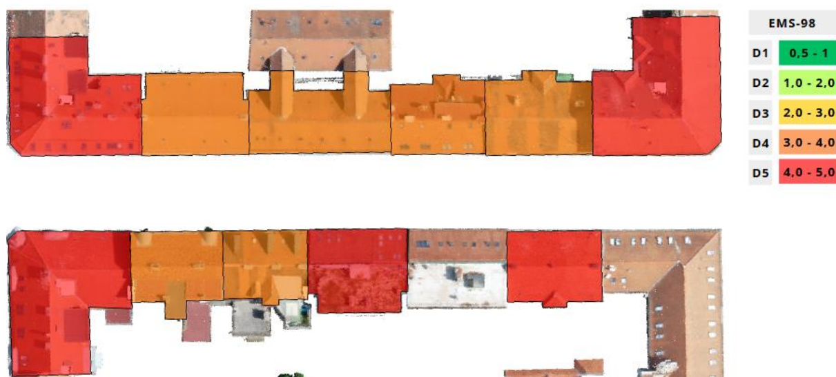
Slika 81.EMS 98 razred oštećenja za intenzitet VIII
