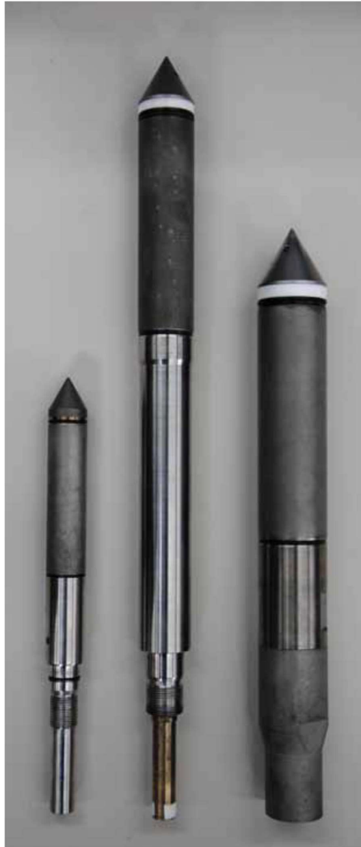
Slika 20 CPTU sonde (Izvor: [33])
