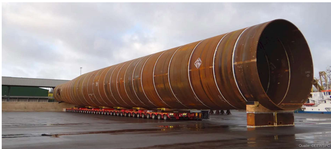
Slika 6 XL pilot za temeljenje vjetroturbine (Izvor: [17])
