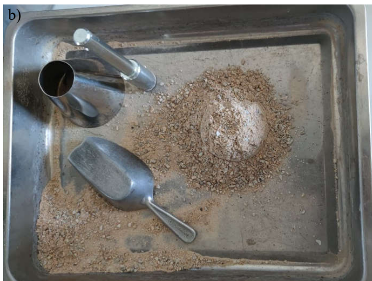
Slika 6-9 Određivanje gustoće i upijanje vode: a) piknometar; b) određivanje površinski suhog stanja uzorka frakcije 0,063/4 mm
