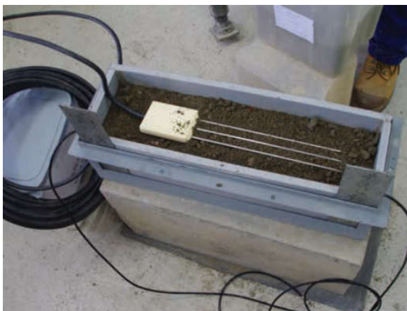
Slika 5-12 Položaj TDR sonde unutar kalupa [257]
