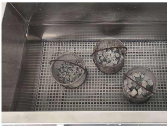
Slika 6-10 Ispitivanje otpornosti na smrzavanje metodom natrijevog sulfata
