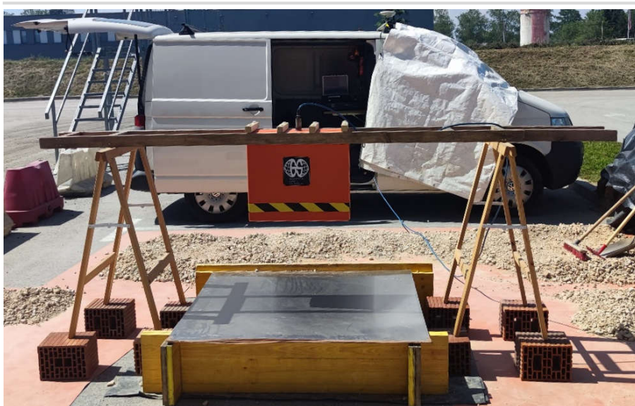
Slika 7-9 Air-coupled antena za vrijeme kalibracije
