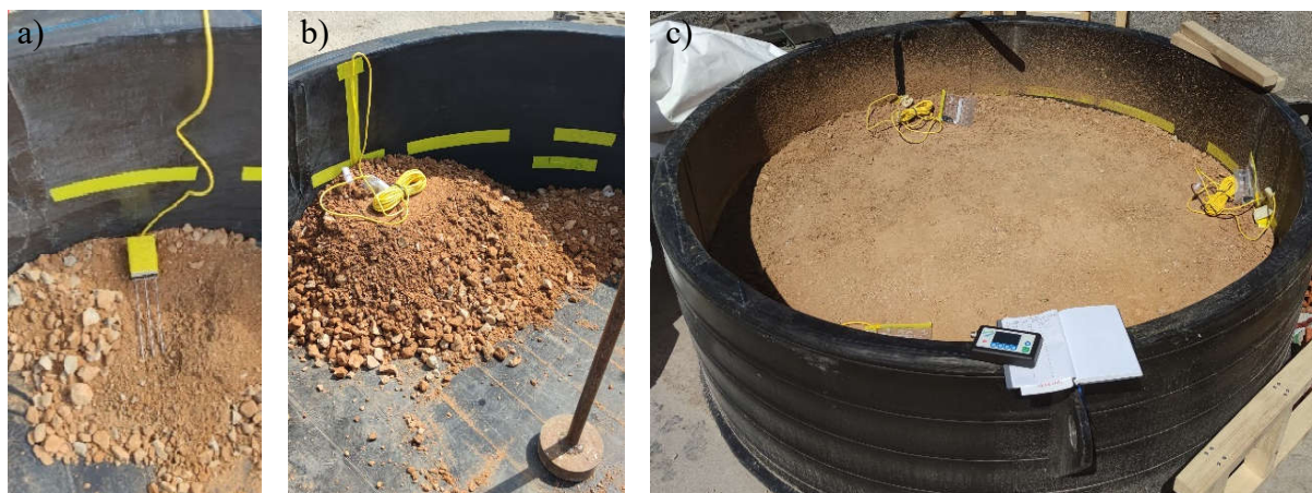
Slika 7-5 Instalacija TDR sonda: a) postavljanje sonde na određenoj dubini; b) primarno ručno zbijanje; c) uzorak s tri ugrađene sonde
