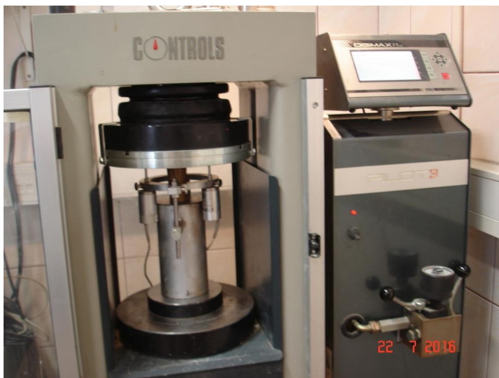
Slika 7.1. Uređaja za ispitivanje kompresijom (jednoosne tlačne čvrstoće) u laboratoriju Zavoda za geotehniku na Građevinskm fakultetu Sveučilišta u Zagrebu
