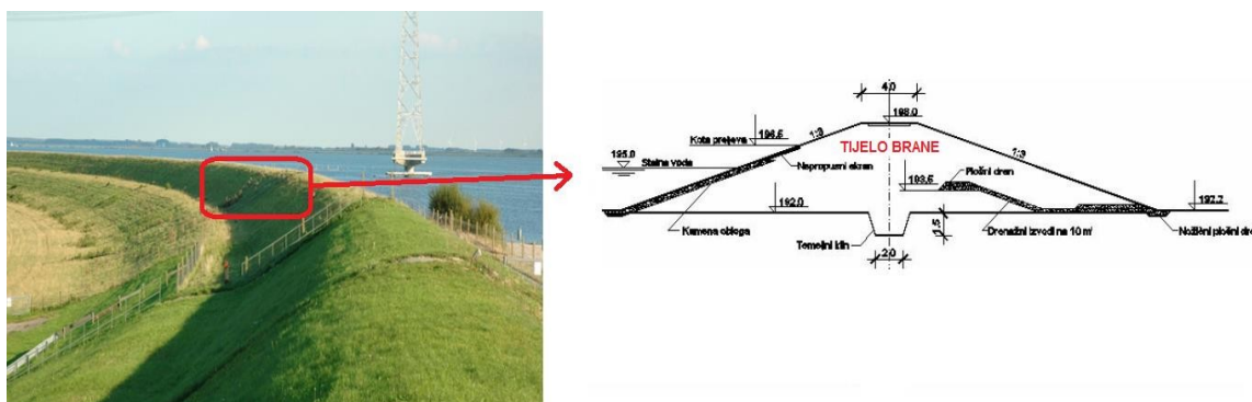
Slika 4.26. Tipični poprečni presjek nasipa (SEPA, 2014)
