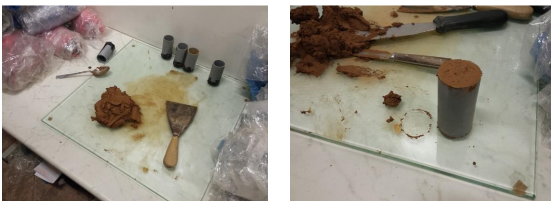
Slika 7.7. Formiranje uzorka, stavljanje smjese gline i veziva u plastični kalup
