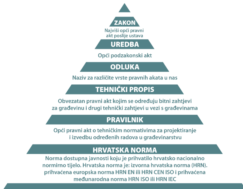
Grafikon 8. Hijerarhijska sistematizacija pravnih akata koji se odnose na upravno područje gradnje u RH (prilagođeno od Zagorec, 2012)
