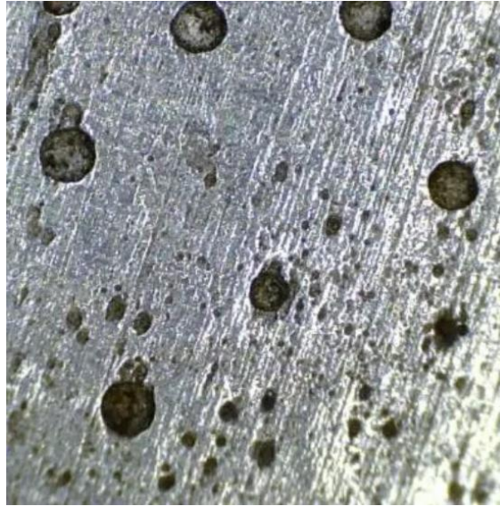
Slika 9.: Primjer rupičaste korozije [12]
