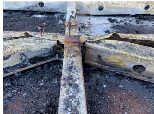
Slika 35: a) Izvijanje dijagonala na čvoru 11 nakon ispitivanja Panela 2 b) Čelični vijci nakon ispitivanja
