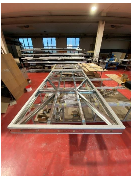
Slika 5: Nosiva čelična konstrukcija
