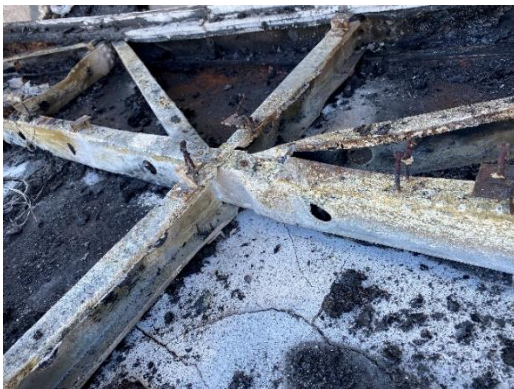
Slika 35: a) Izvijanje dijagonala na čvoru 11 nakon ispitivanja Panela 2 b) Čelični vijci nakon ispitivanja
