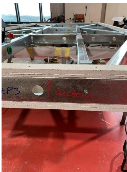
Slika 11: Oznaka izložene strane uzorka panela
