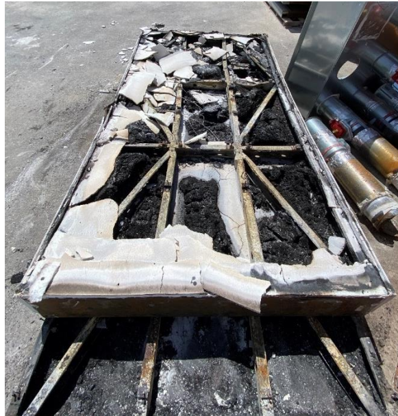
Slika 34: Panel 2 nakon ispitivanja
