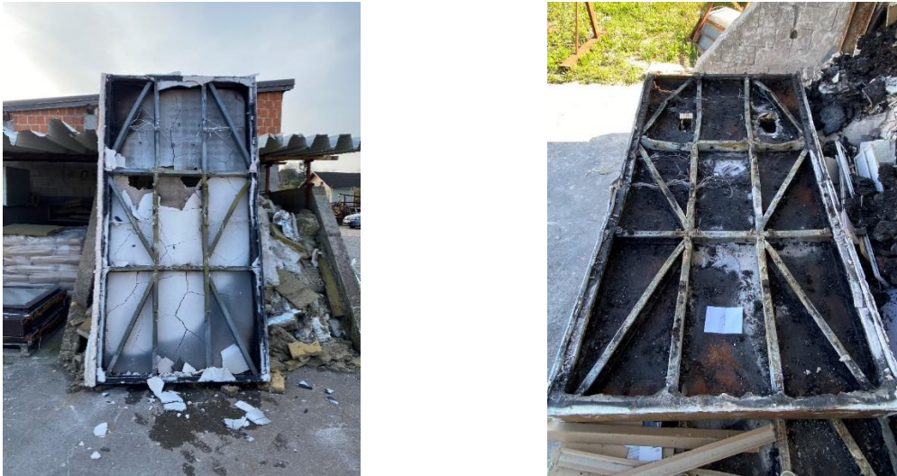
Slika 38: Paneli nakon ispitivanja a) Panel 1 b) Panel 2
