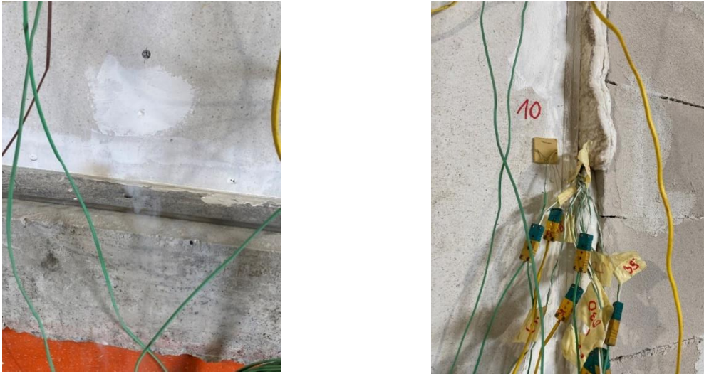
Slika 20: a) Učvršćenje uzorka panela na betonski prag peći b) Keramička vuna, blokovi od autoklaviranog porobetona i termoelementi na slobodnim krajevima praznog panela
