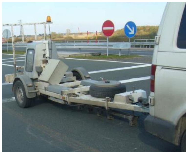
Slika 23 Uređaj s padajućim teretom montiran na prikolicu (preuzeto iz Rukavina, 2017)
