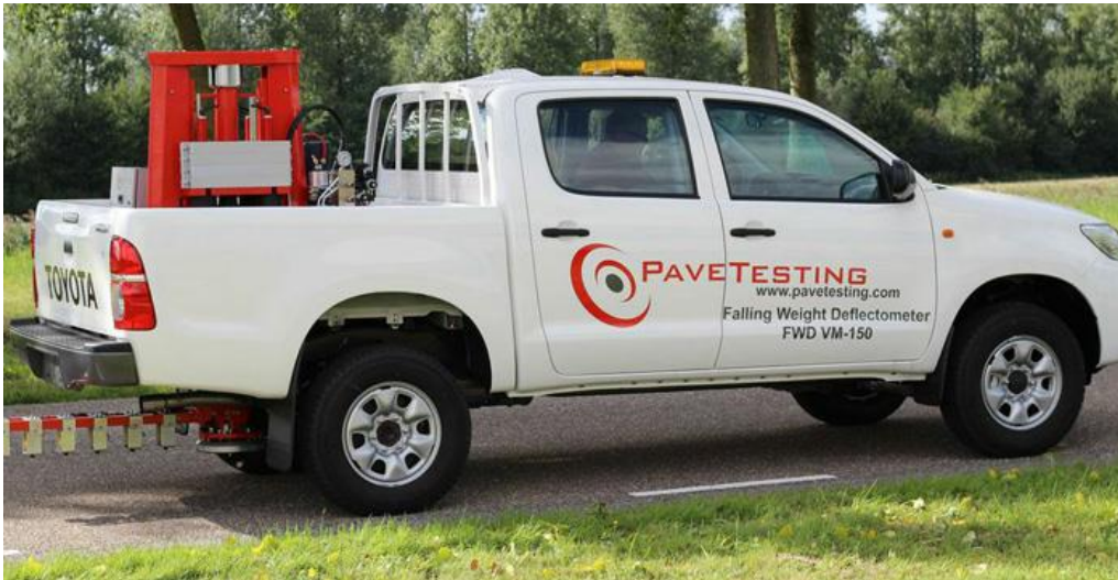
Slika 24 Uređaj s padajućim teretom ugrađen u vozilo (preuzeto iz Rukavina, 2017)
