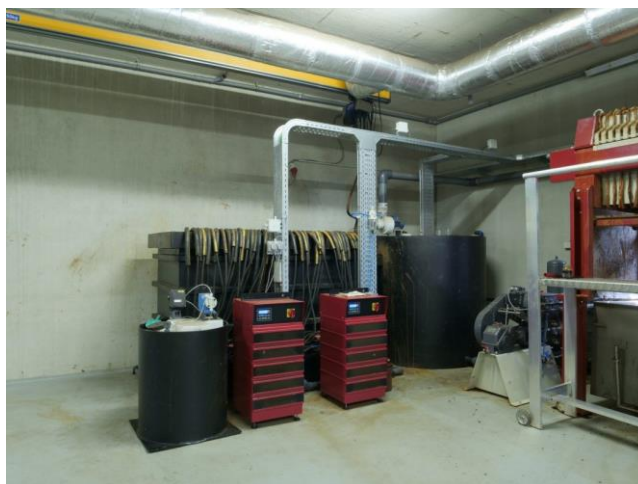
Slika 29: Potrebna aparatura za proces elektroagulacije [72]
