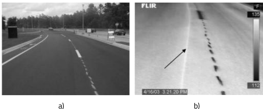
Slika 28. Prikaz spoja a) digitalnom kamerom i b) termalnom kamerom [25]
