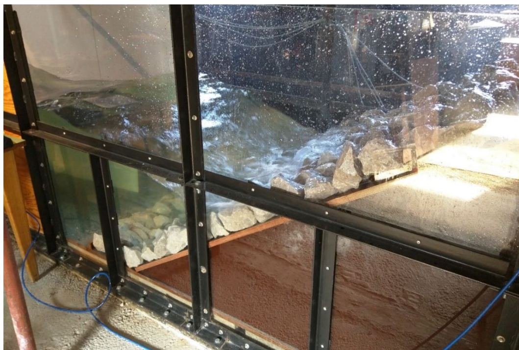
Slika 18 Incidenti val koji djeluje na fizički model lukobrana u slučaju kada je propust u potpunosti uronjen (W1)
