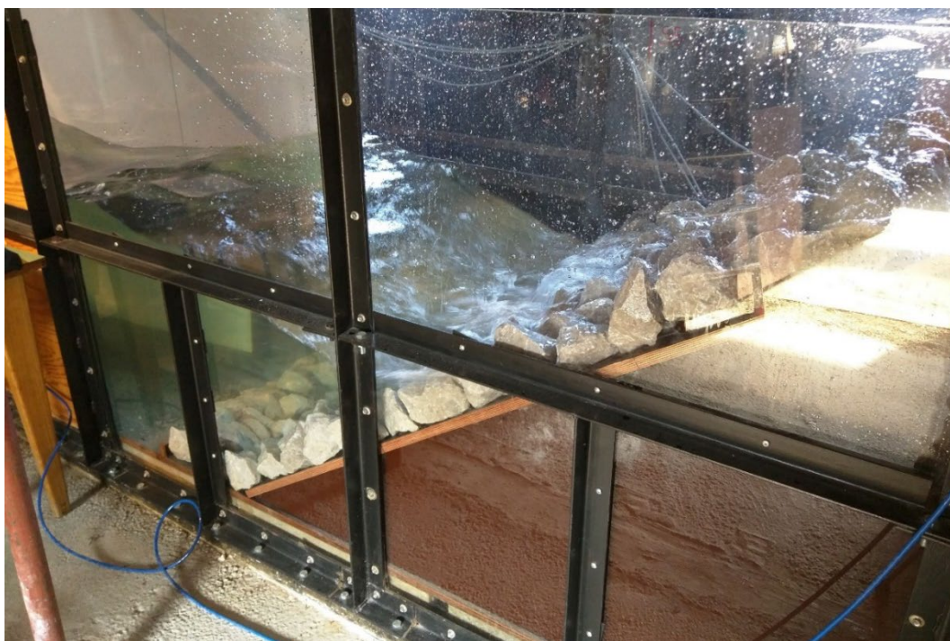
Slika 18 Incidentni val koji djeluje na fizički model lukobrana u slučaju kada je propust u potpunosti uronjen (W1)
