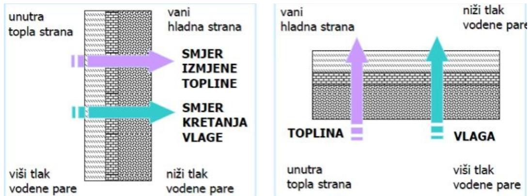
Slika 4: Smjer kretanja topline i vlage
