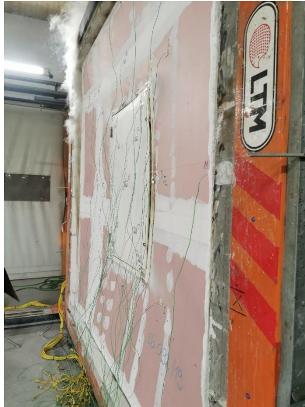
Slika 46. Deformacije revizijskih vrata (uzorak 1)
