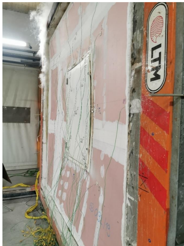
Slika 27. Deformacije požarnih revizijskih vrata
