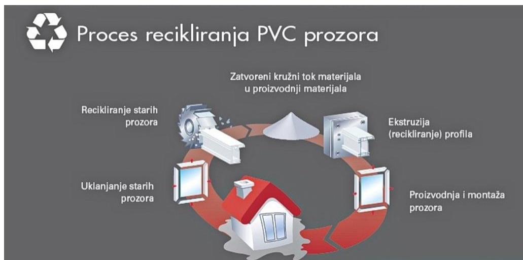
Slika 3.6. Proces recikliranja PVC prozora
