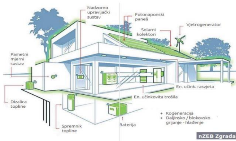
Slika 4.1. Zgrada s nultom potrošnjom energije
