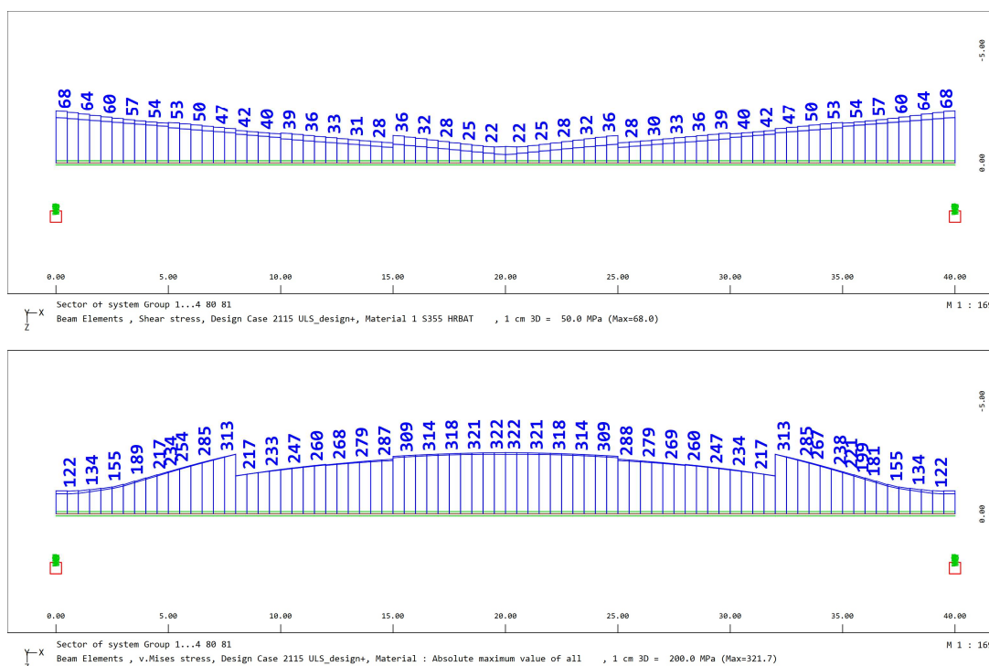
Slika 7.24. Prikaz posmičnih napreznaja i V. Mises napreznaja u hrptu
