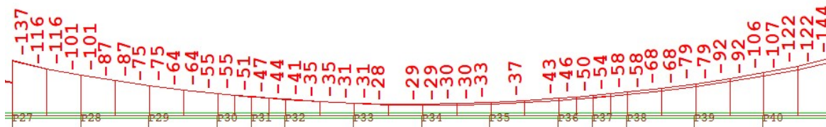
Slika 6.8. Najveće tlačno naprezanje za provjeru stabilnosti pojasnice debljine 20 mm
