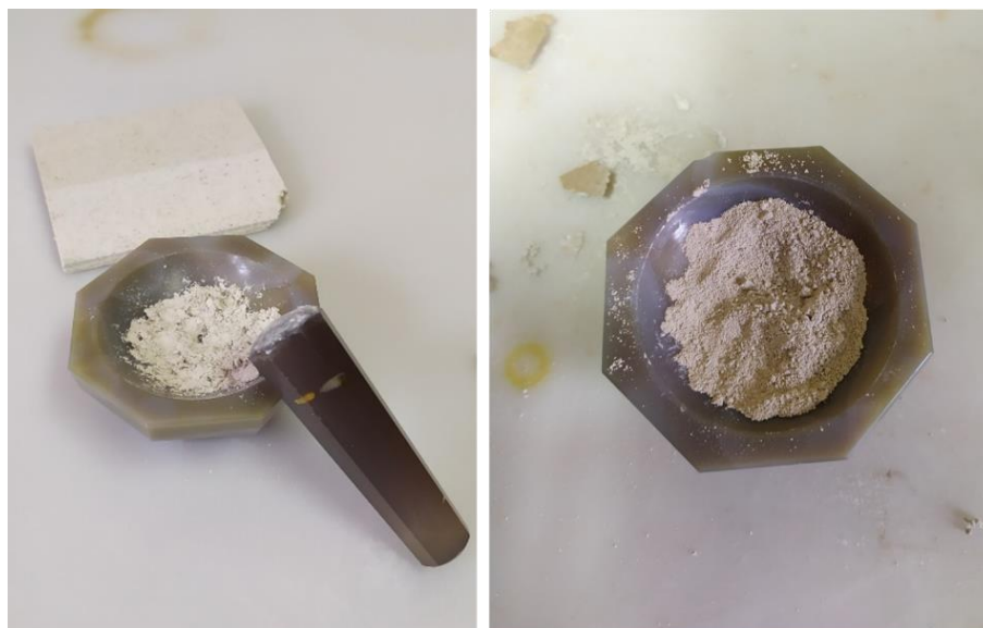
Slika 10. Priprema uzoraka gips-vlknaste i gips-kartonske ploče
