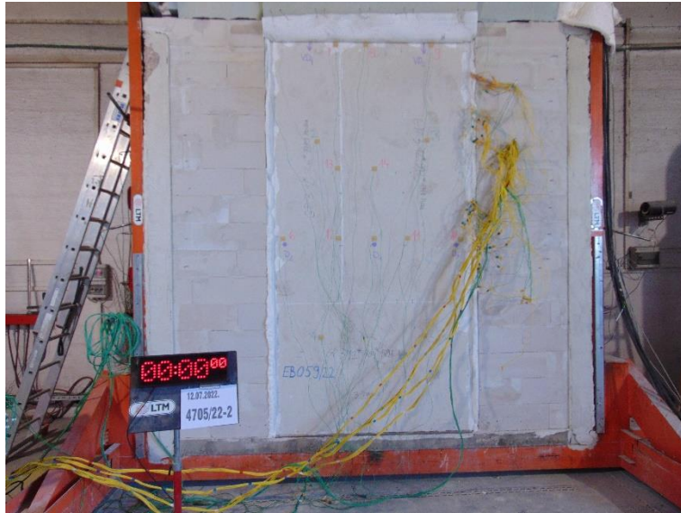
Slika 46. PANEL 2 prije ispitivanja otpornosti na požar
