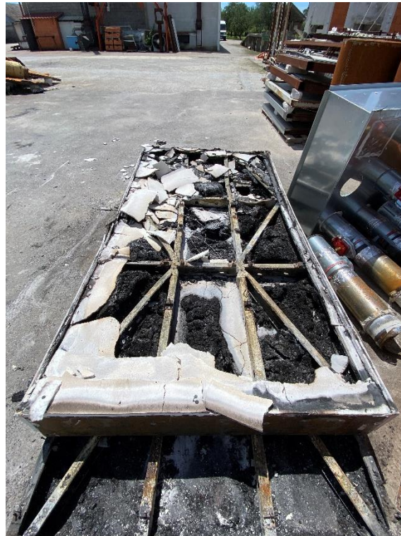
Slika 45. PANEL 1 nakon ispitivanja otpornosti na požar
