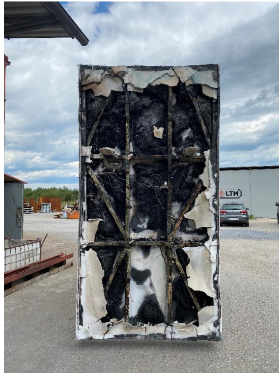
Slika 47. PANEL 2 nakon ispitivanja otpornosti na požar
