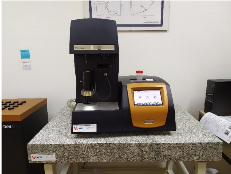
Slika 12. TGA uređaj, Građevinski fakultet Sveučilišta u Zagrebu
