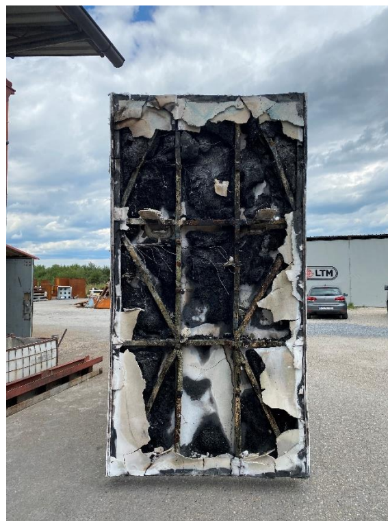
Slika 47. PANEL 2 nakon ispitivanja otpornosti na požar
