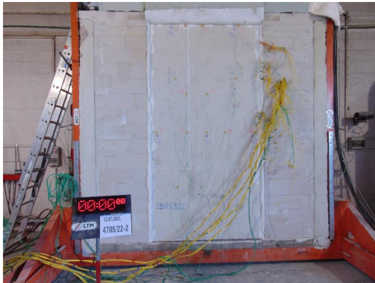
Slika 46. PANEL 2 prije ispitivanja otpornosti na požar
