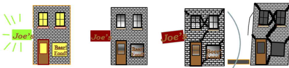
Slika 2.2 Četiri razine oštećenja koje definira FEMA
