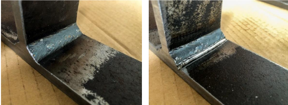
Slika 5.7. AW (lijevo) i HFMI obrađeni (desno) TA detalj (S355J2+N)
