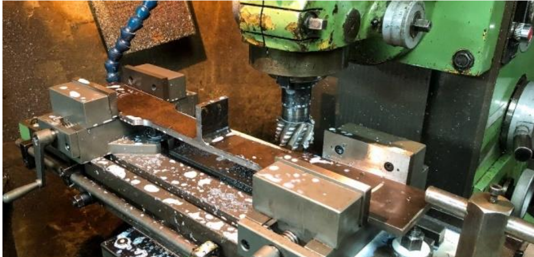
Slika 5.5. Prikaz glodanja uzoraka – izrada uzoraka za laboratorijsko ispitivanje
