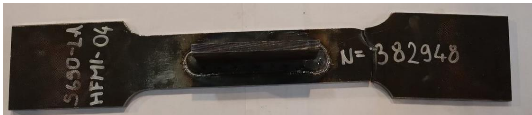
Slika 5.45. Uzorak S690-LA-HFMI-04 koji je otkazao u osnovnom materijalu
