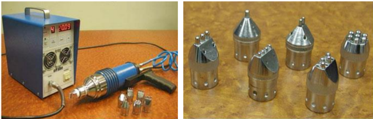
Slika 2.10. Primjer HFMI uređaja i različitih dostupnih HFMI glava [15]
