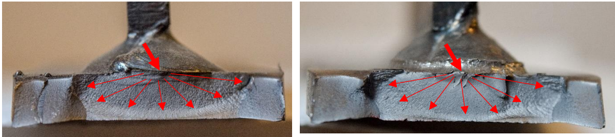
Slika 5.46. Plohe loma uzorka S690-LA-AW-01 (lijevo) i S690-LA-HFMI-03 (desno)
