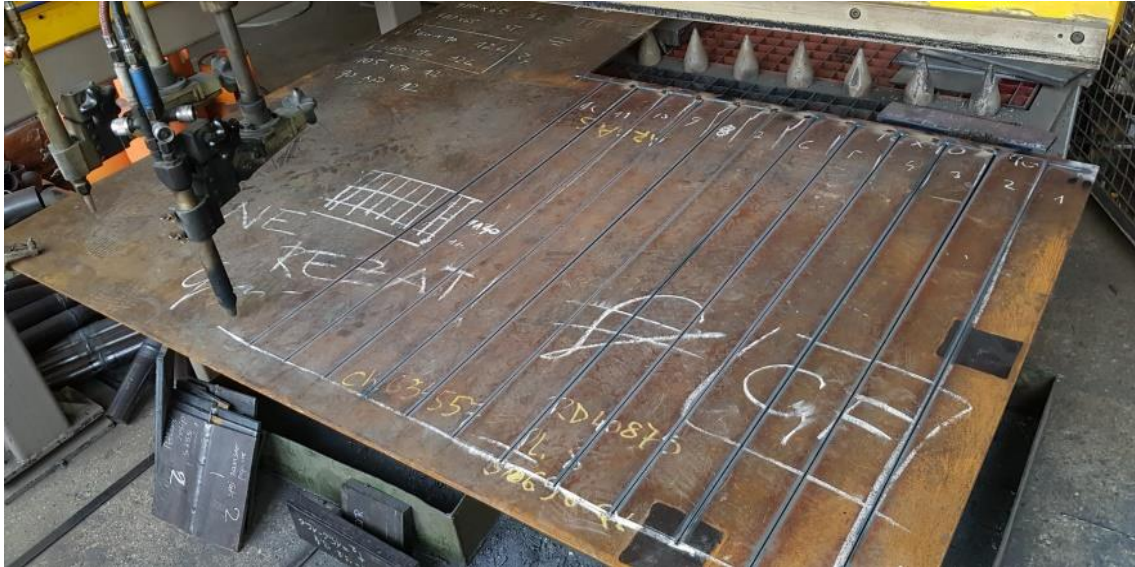
Slika 5.1. Rezanje čelične ploče S690QL nominalne debljine 8 mm
