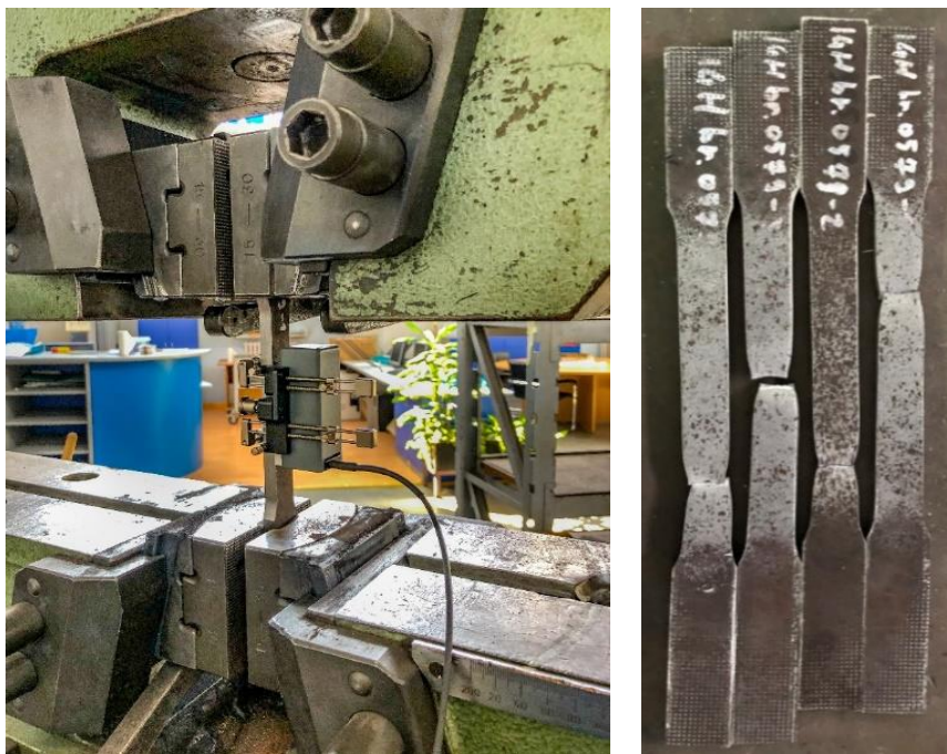
Slika 5.16. Vlačno ispitivanje mehaničkih karakteristika osnovnog materijala
