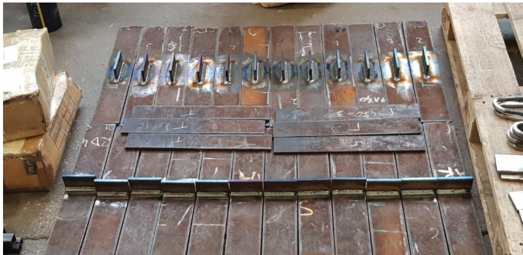
Slika 5.3. Zavarena uzdužna i poprečna ukrućenja na izrezane ploče S690QL
