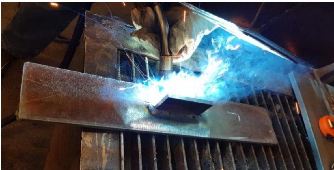
Slika 5.2. Zavarivanje uzdužnog ukrućenja na ploču (LA detalj)
