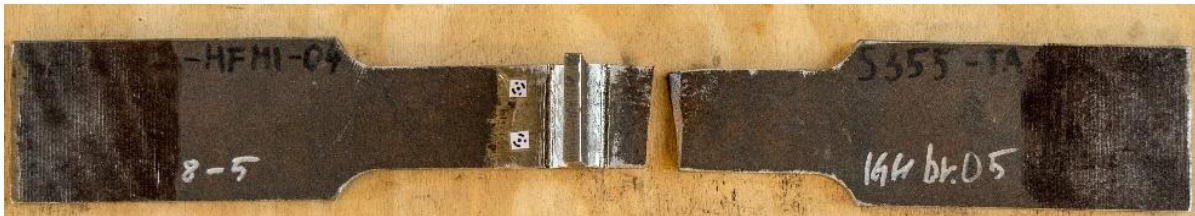
Slika 5.35. Uzorak S355-TA-HFMI-04 koji je otkazao u osnovnom materijalu (dolje)
