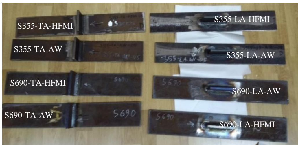
Slika 5.22. Uzorci za mjerenja zaostalih naprezanja
