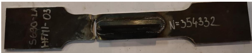
Slika 5.44. Uzorak S690-LA-HFMI-03 koji je otkazao na rubu zavora
