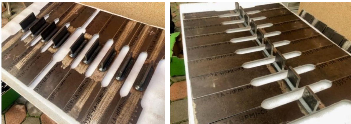
Slika 5.6. Izrađeni laboratorijski uzorci, LA detalj (lijevo) i TA detalj (desno)
