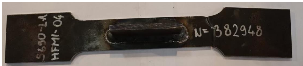
Slika 5.45. Uzorak S690-LA-HFMI-04 koji je otkazao u osnovnom materijalu
