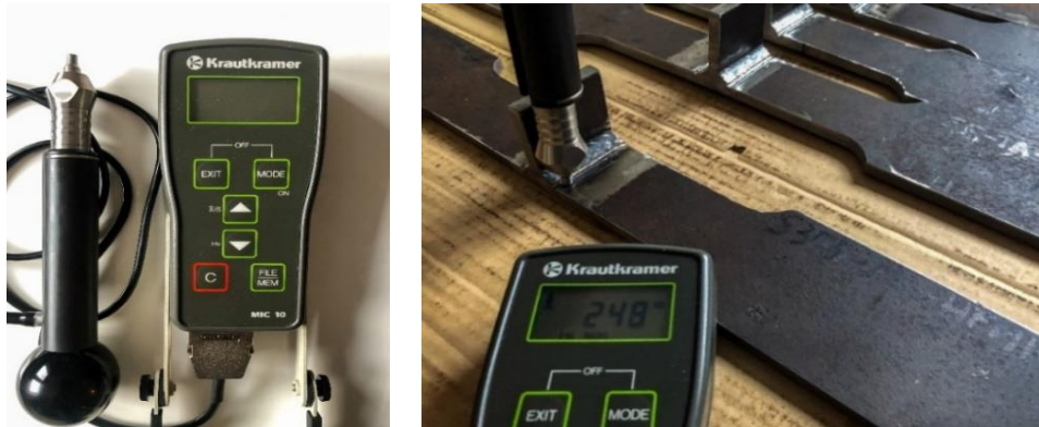
Slika 5.20. Uređaj za mjerenje tvrdoće (lijevo) i mjerenje tvrdoće na uzorcima (desno)
