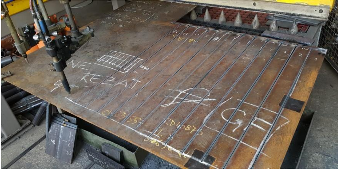
Slika 5.1. Rezanje čelične ploče S690QL nominalne debljine 8 mm
