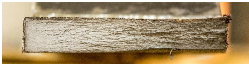
Slika 5.37. Ploha loma uzorka S355-TA-HFMI-04
