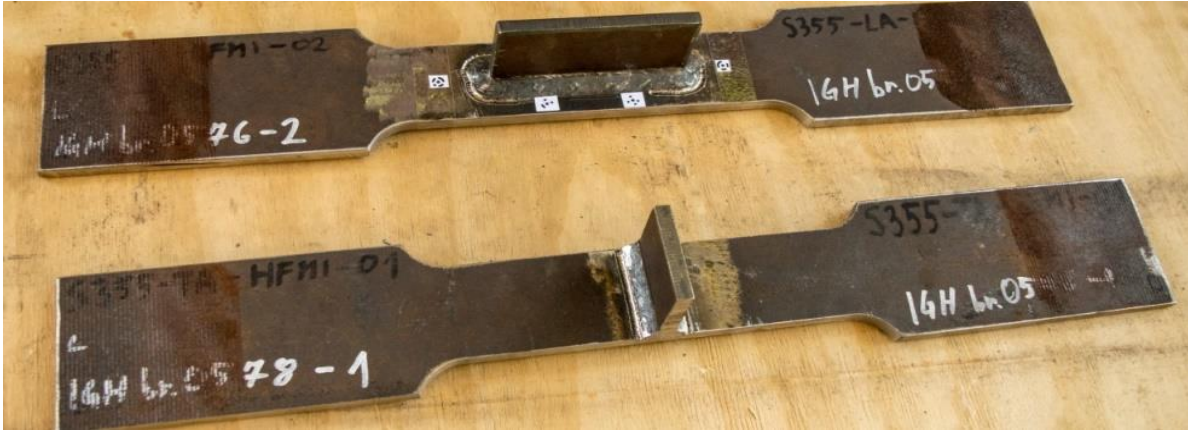
Slika 5.34. Uzorci S355-LA-HFMI-02 i S355-TA-HFMI-01 koji nisu otkazali („run out“)
