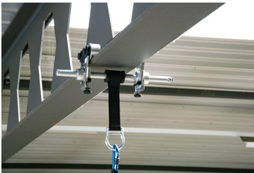
Slika 29 Pričvršno sredstvo za vezanje radnika za čeličnu gredu (XS Platforms, 2023)
