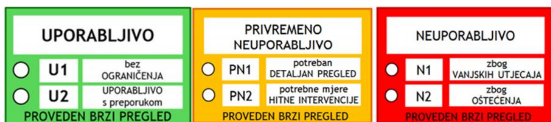
Slika 10 Naljepnice oštećenja građevina
