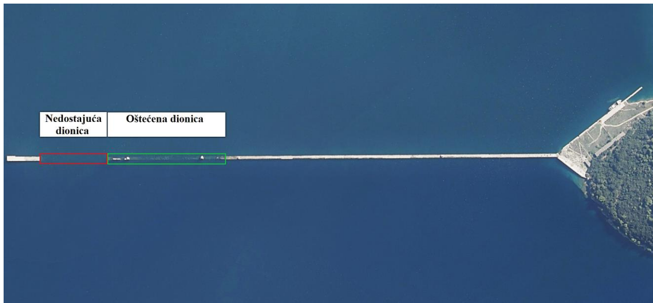
Slika 2. Lukobran Pula u 2D prikazu s detaljem nedostajućeg dijela [2]
