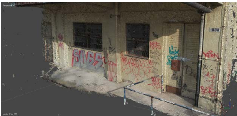
Slika 25 Model dobiven dodatnom snimkom
