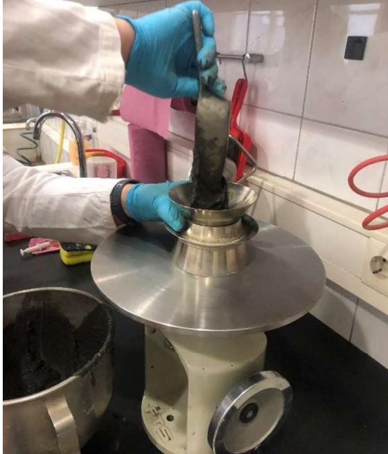
Slike 15. i 16. Mjerenje konzistencije mješavine M-2
