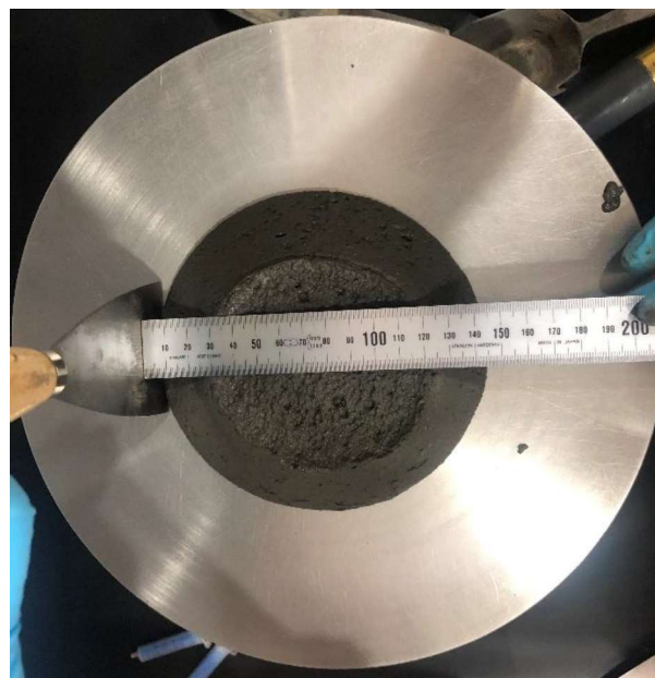
Slike 11. i 12. Ispitivanje konzistencije mješavine M-1
