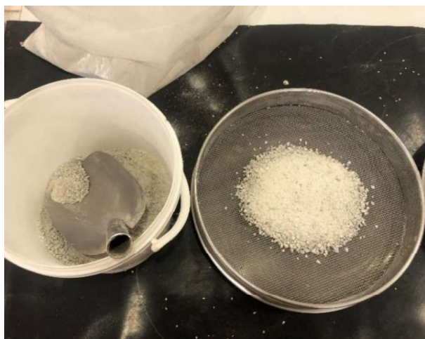
Slika 6. Prikaz prosijavanja agregata
