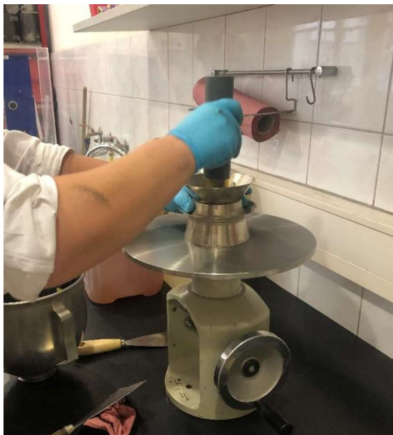
Slike 11. i 12. Ispitivanje konzistencije mješavine M-1
