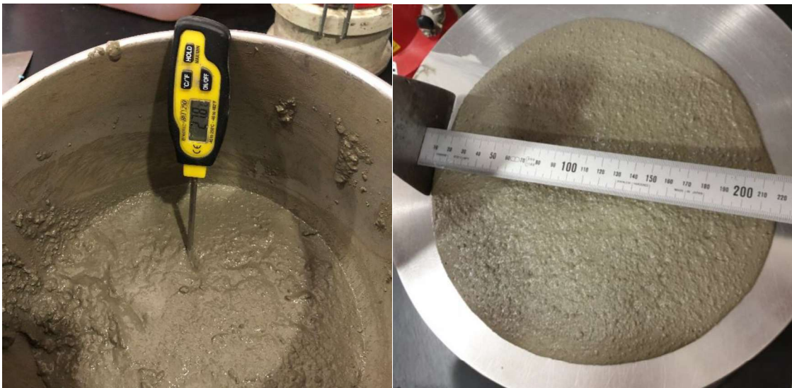
Slika 21. i 22. Prikaz mjerenja temperature i konzistencije betona u svježem stanju mješavine M-4
