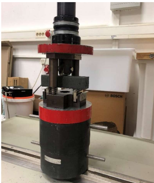
Slike 25. i 26. Uzorak prije i nakon ispitivanja na vlačnu čvrstoću
