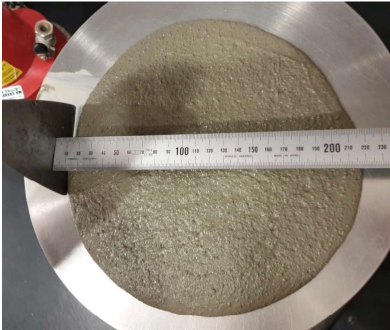
Slika 19. Mjerenje konzistencije mješavine M-3
