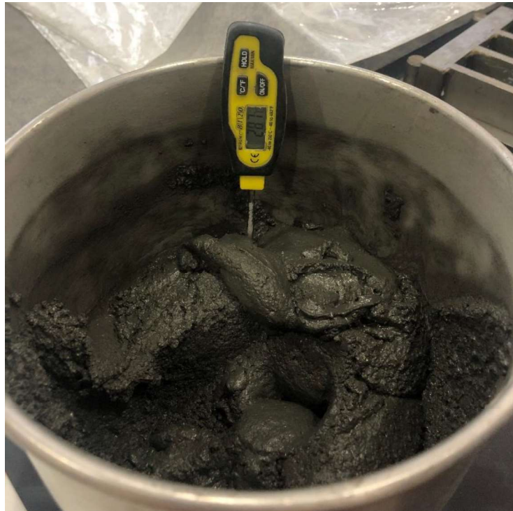
Slika 10. Prikaz mjerenja temperature betona u svježem stanju mješavine M-1
