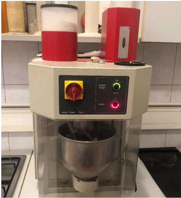
Slika 8. Miješanje komponenti betona u miješalici
