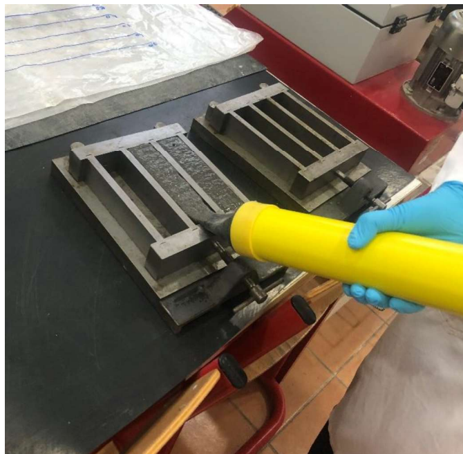
Slika 17. Simulacija ručnog 3D printanja betona mješavine M-2 u kalup
