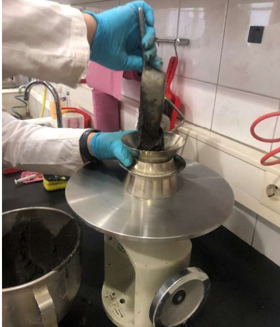
Slike 15. i 16. Mjerenje konzistencije mješavine M-2
