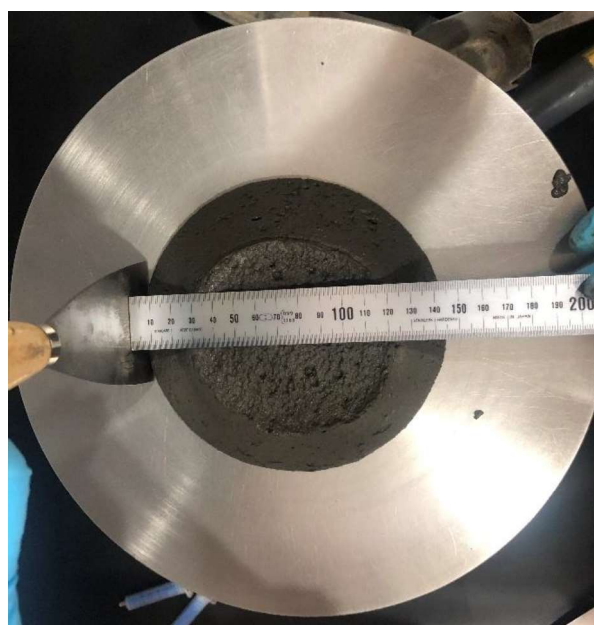
Slike 11. i 12. Ispitivanje konzistencije mješavine M-1
