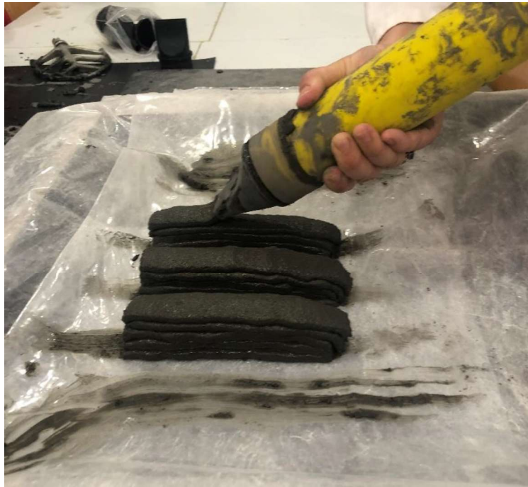
Slika 13. Simulacija ručnog 3D printanja betona mješavine M-1
