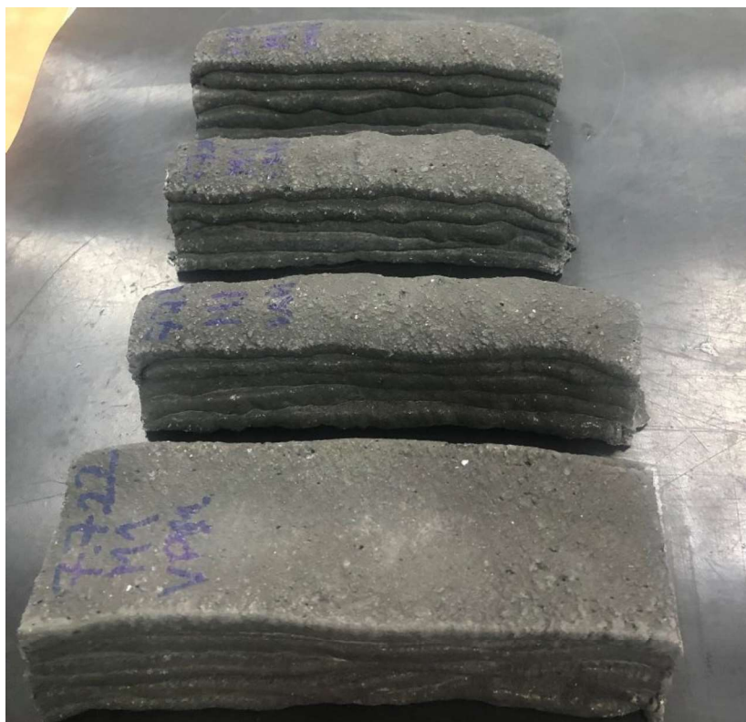
Slika 29. Uzorci simulirano 3D printanog betona mješavine M-1, nakon 42 dana
