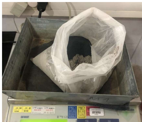
Slika 7. Prikaz mjerenja cementa, letećeg pepela i silicijske prašine
