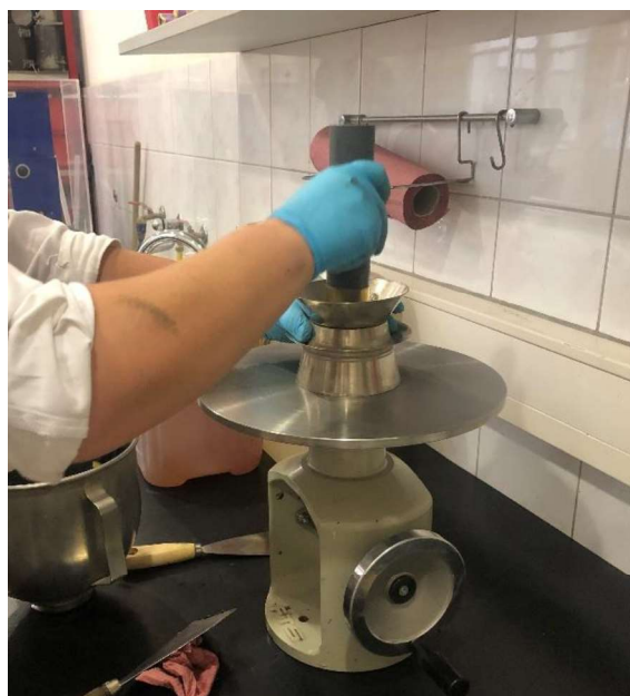
Slike 11. i 12. Ispitivanje konzistencije mješavine M-1
