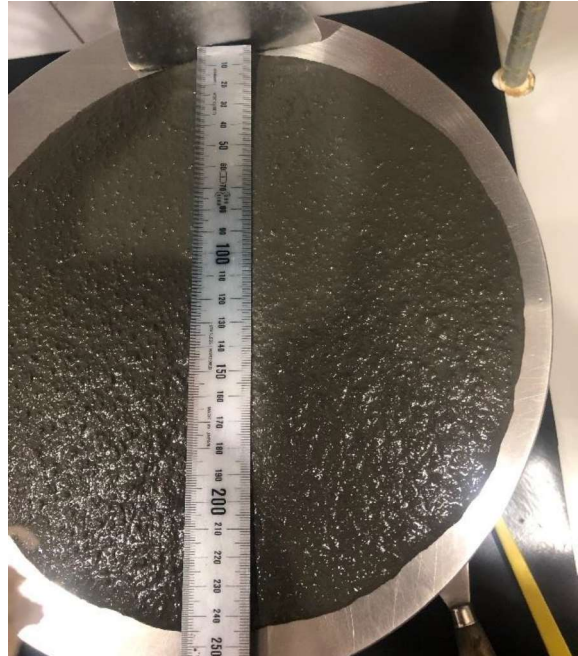
Slike 15. i 16. Mjerenje konzistencije mješavine M-2
