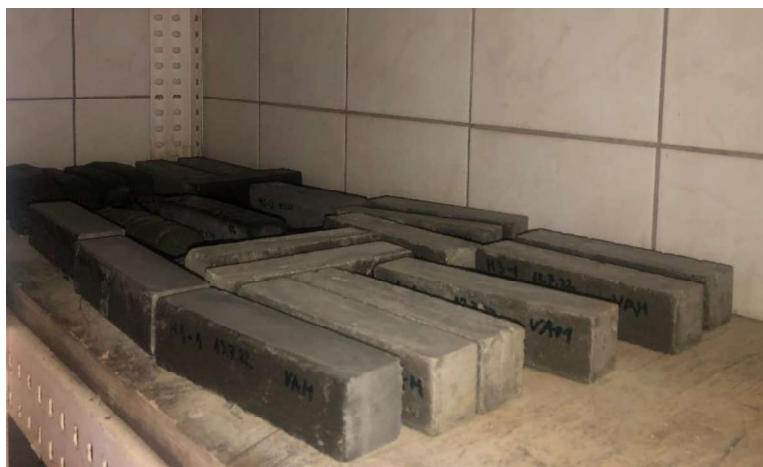
Slika 24. Čuvanje uzoraka u vlažnoj komori
