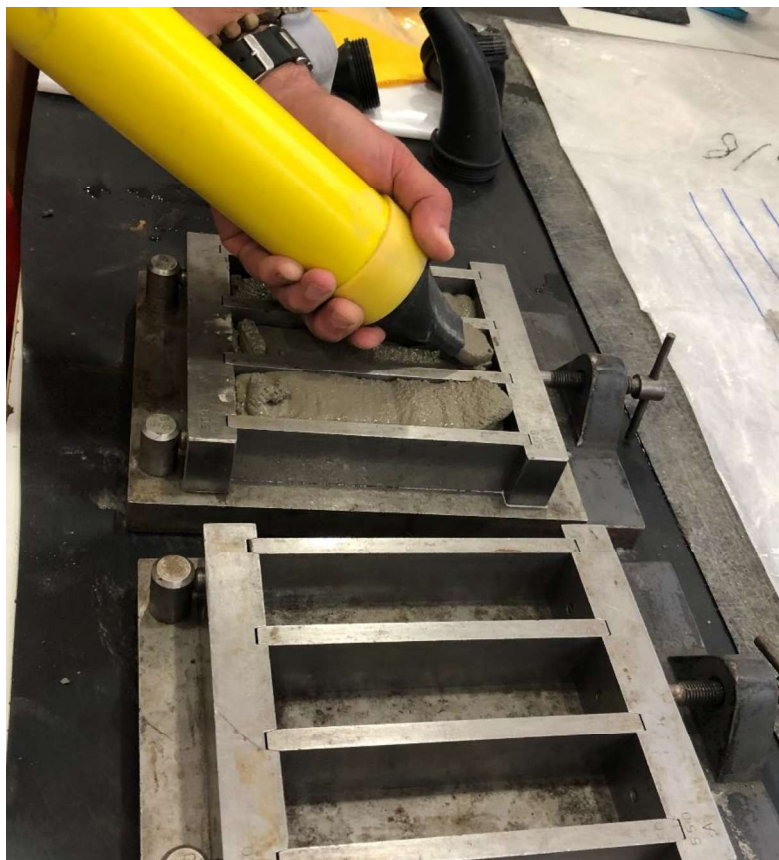
Slika 20. Simulacija ručnog 3D printanja mješavine M-3 u kalup
