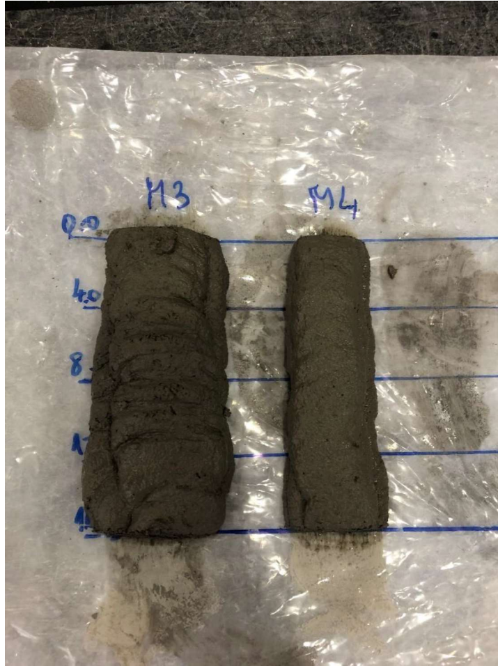
Slika 23. Prikaz isprintanog 3D betona ručnom simulacijom mješavine M-3 i M-4
