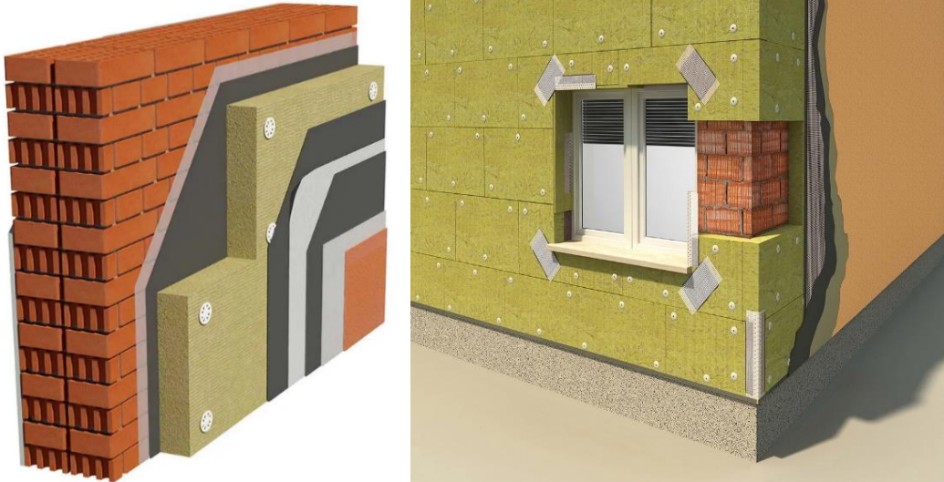
Slika 4. Ugrađeni sloj kamene vune u vanjsku ovojnicu zgrade i Slika 5. Prikaz izvedbe vanjske izolacije kamenom vunom
