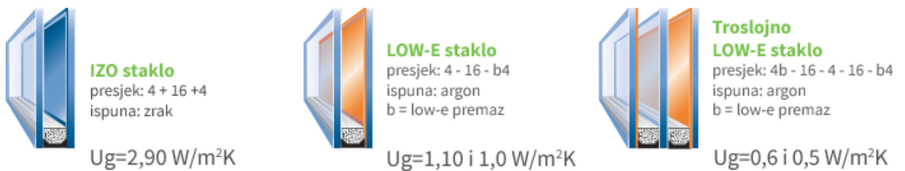
Slika 24. Usporedba toplinske provodljivosti u kombinacijama izo-stakla i low-e premaza
