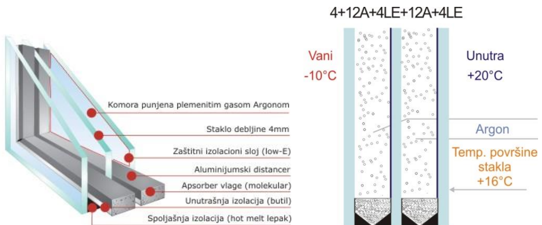
Slika 24. Usporedba toplinske provodljivosti u kombinacijama izo-stakla i low-e premaza
