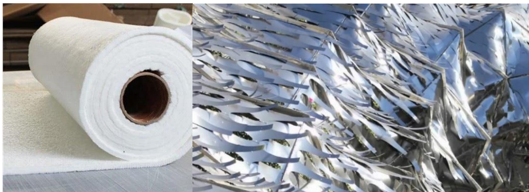
Slika 6. Pametni izolacijski materijali – aerogel i termobimetal
