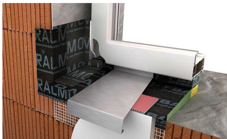
Slika 13. Detalj izvedbe vanjske britve ugradnjom vodonepropusne, a paropropusne folije
