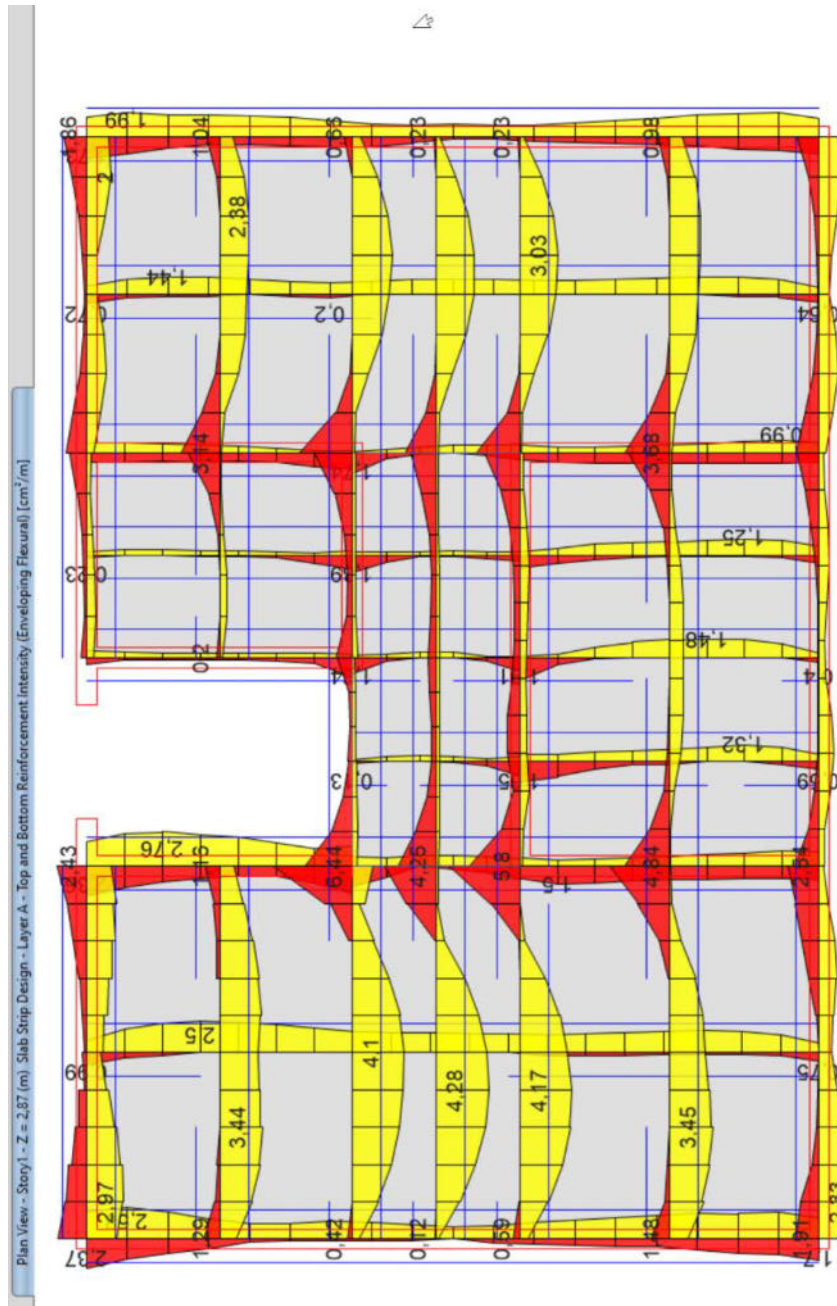
Slika 3.7. : Armatura međukatne konstrukcije
