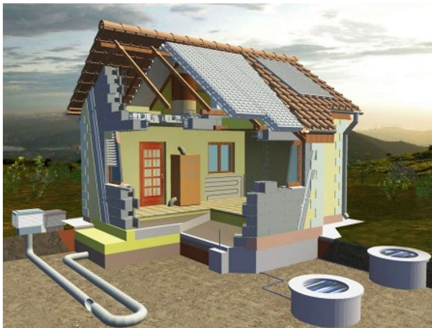
Slika 6. Korišteni materijali za masivnu gradnju na presjeku kuće Izvor: gradimo.com: Tehnologija gradnje pri pasivni hiši | Gradimo.com
