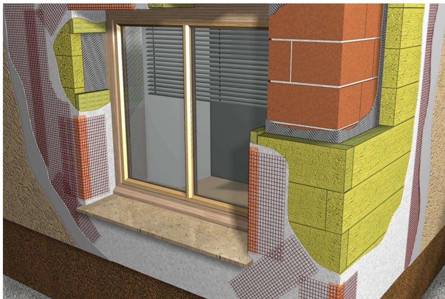
Slika 8. Izvedba slojeva toplinske izolacije
