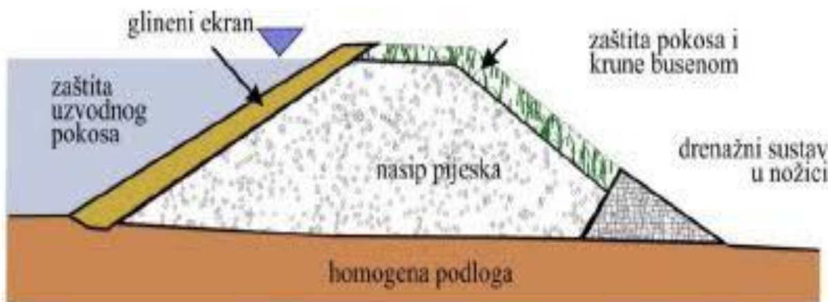
Slika 8. Presjek nasipa s glinenim ekranom.
