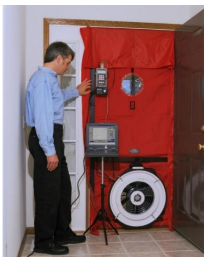
Slika 29. Provođenje "blower door" testa
