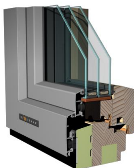
Slika 12. Presjek okvira prozora aluminij + drvo
