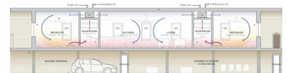
Slika 44. Nacrt niskoenergetske kuće
